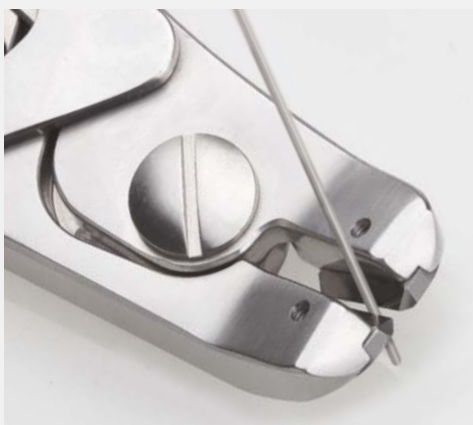
Schneiden von K-Draht mit dem EasyCut
