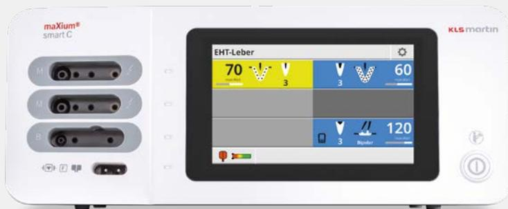
Die bipolare Stromart „Neptun“ des HF-Generators maxium® wurde speziell für die flüssigkeitsunterstützte HF-Koagulation entwickelt (**EHT = Elektrohydrothermosation**). Diese Methode hat sich speziell bei Anwendungen in der Viszeral- und Neurochirurgie bewährt. Die Stromart ist an die Bedürfnisse der bipolaren Spülpinzetten nonStick flush angepasst.
