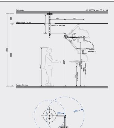
89-100-55-04 marLED® X Operationsleuchte — deckenmontiert, Standard
