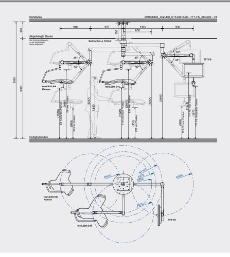
89-100-64-04  $mar LED^{\circledast} \ OPL\text{-}Kombination \ E15/E9i\text{+}Kamera/TFT\text{-}FS \ AC3000-deckenmontiert, \ Standard$
