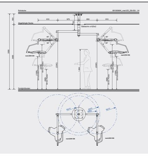
89-100-58-04  $\label{eq:continuous} {\it marLED@OPL-Kombination E9i/E9i-deckenmontiert, Standard}$
