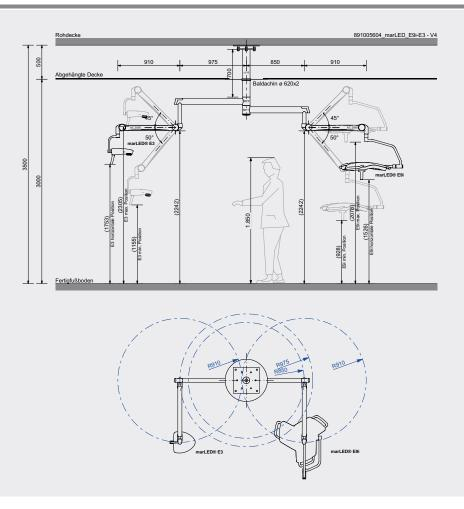
89-100-56-04  $mar LED^{\circledR} \ OPL\mbox{-}Kombination \ E9i/E3- \\ deckenmontiert, \ Standard$
