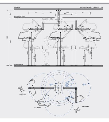
89-100-66-04  $\label{eq:continuous} \mbox{ marLED@ OPL-Kombination E9i/E15/E15} - \mbox{ deckenmontiert, Standard}$
