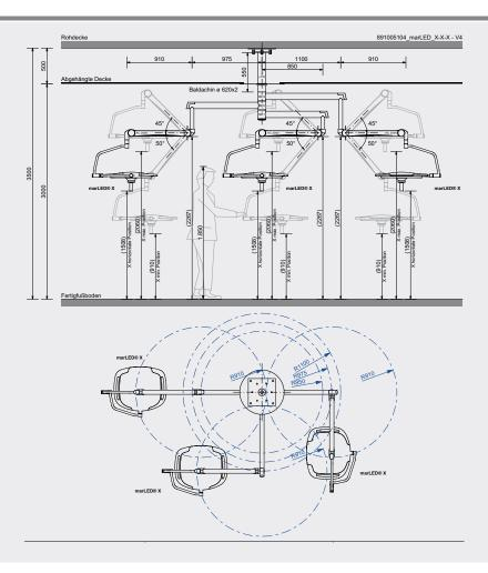
89-100-51-04  $\label{eq:continuous} \mbox{marLED} ^{\circledast} \mbox{ OPL-Kombination X/X/X} - \mbox{ deckenmontiert, Standard}$
