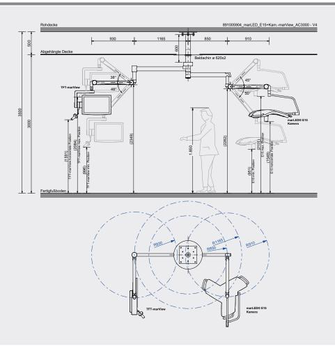
89-100-59-04  $mar LED^{\circledast} \ OPL\text{-}Kombination E15+Kamera/mar View AC3000} - \\ deckenmontiert, \ Standard$
