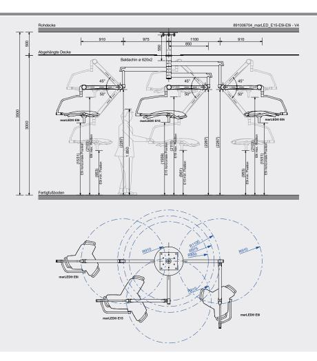
89-100-67-04  $mar LED^{\circledast} \ OPL\text{-}Kombination \ E15/E9i/E9i - deckenmontiert, \ Standard$
