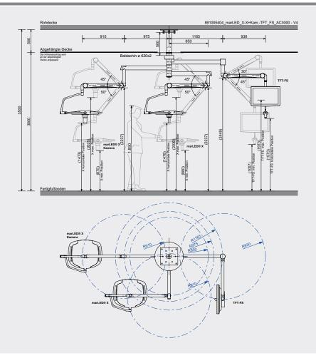
89-100-54-04  $marLED @ \ OPL-Kombination \ X/X+Kamera/TFT-FS \ AC3000-deckenmontiert, \ Standard$
