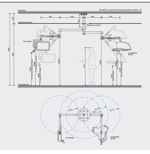
89-100-57-04  $mar LED^{\circledast} \ OPL\text{-}Kombination \ E9i+Kamera/mar View \ AC3000-deckenmontiert, \ Standard$
