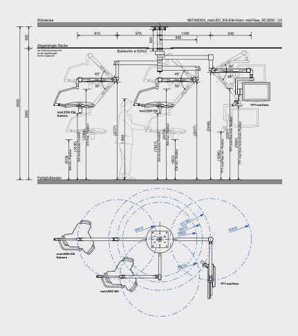
89-100-63-04  $mar LED @ \ OPL-Kombination \ E9i/E9i+Kamera/mar View \ AC3000-deckenmontiert, \ Standard$
