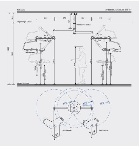
89-100-60-04  $\label{eq:constraint} {\rm marLED}^{\circledast} \mbox{ OPL-Kombination E9i/E15} - {\rm deckenmontiert, Standard}$
