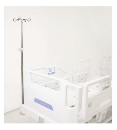
Höhenverstellbare Infusions-Stange aus Edelstahlrohr mit 4 Edelstahlhaken, die in den dafür vorgesehenen Aufnahmen an den 4 Ecken der Matratzenplattform zu montieren sind. Min. Höhe 81 cm - max. Höhe 151 cm Maximale Belastung: 1,25 kg pro Haken. Gewicht: 1,5 kg.
