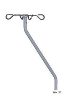
Infusions-Stange aus rundem, lackiertem Stahlrohr, zum Einstecken in die dafür vorgesehenen Aufnahmen an den 4 Ecken des Bettes. Vier Haken aus rostfreiem Stahl. Die Stange ist so geformt, dass sie nicht mit dem Kopfteil kollidiert. Sichere Arbeitslast 5 kg insgesamt (1,25 pro Haken) Gewicht 1,3 kg
